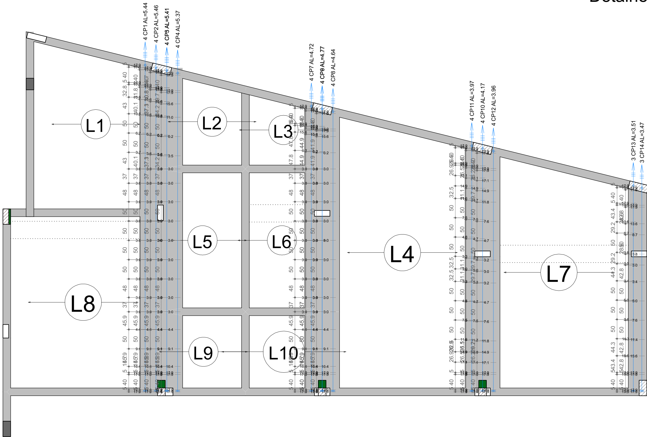
Traçado e distribuição dos cabos do pavimento Laje escala 1:50
